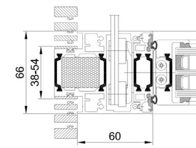
S9-iVt-05 LF-MR\* = fenêtre à lamelles en panneau sandwich (cadre de montage inclus)
